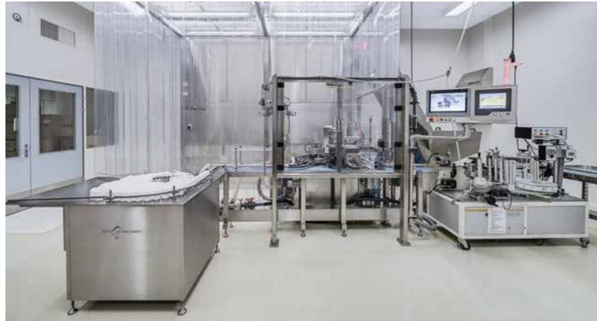
Cette machine est utilisée pour la confection automatique de substances solides conditionnées en boîtes (couvercle à vis ou boîtes en carton).
