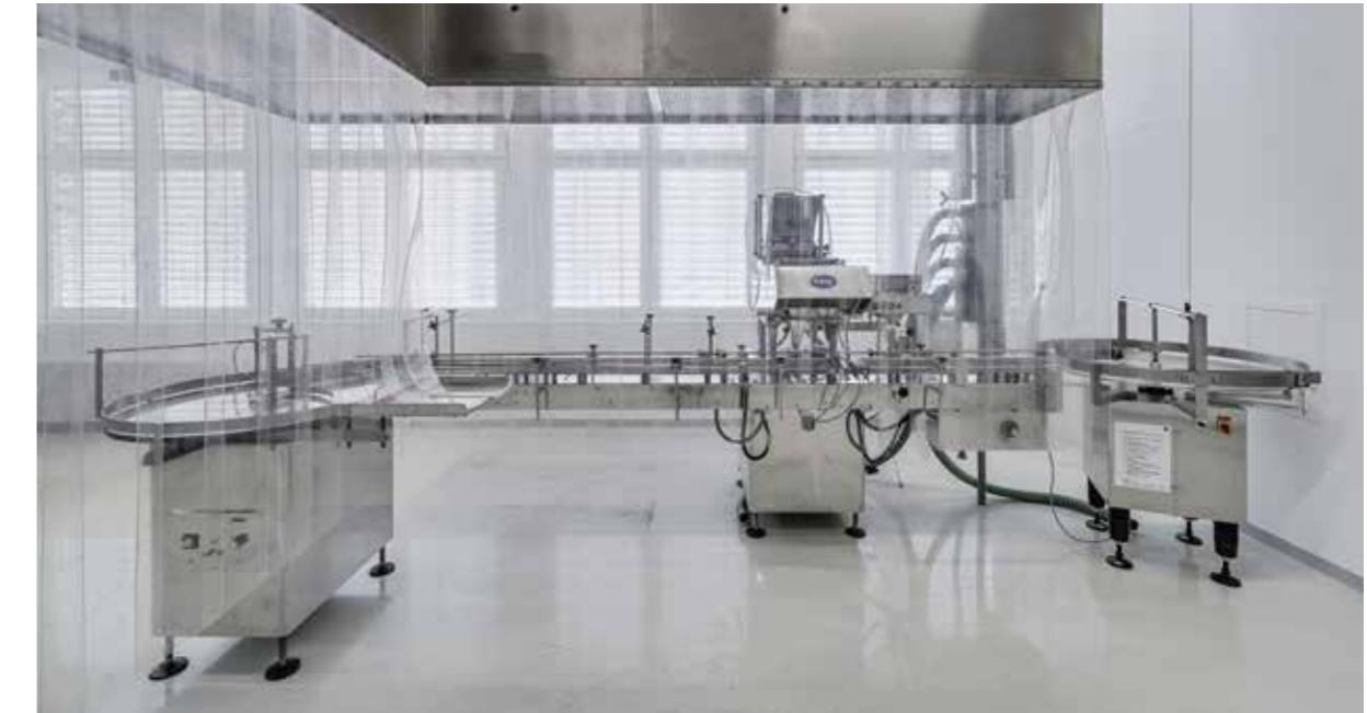
Cette machine est utilisée pour la confection automatique de comprimés, gélules et dragées en boîtes et pots en verre.
